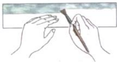
Смазывание деталей клеем
