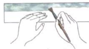
Смазывание деталей клеем
